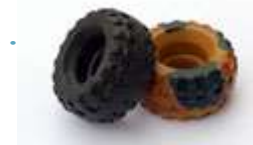
MERIPLAST, matière élastomérique à base de protéines de blé (TEREOS)
